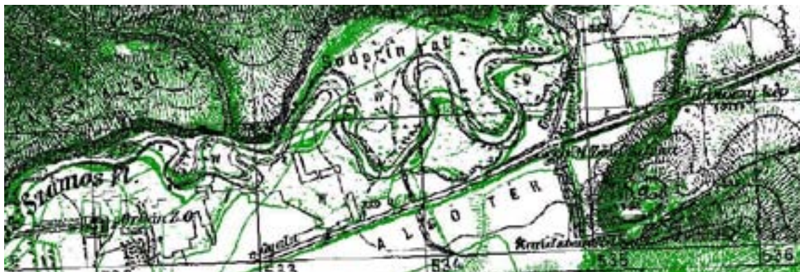
1. ábra. a Kis-Szamos mederfejlődése a második (1870; zöld) és a harmadik (1890 körül; fekete) katonai felmérések egymásra vetített szelvényein. Látható, hogy a kanyarok egyrészt növekedtek, másrészt folyásirány szerint lefelé sodródtak a két felvétel közötti évtizedekben.
