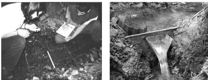
4. ábra. Vízhozammérés úszókkal balról és bukóval jobbról (fotó: saját)
