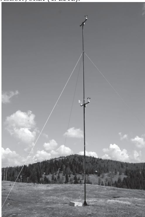
4. ábra: A szélmérő oszlop szélesség és szélirány mérővel
