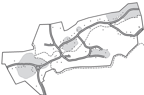
4. ábra: Az 50 mg/l határértéket meghaladó talajvízű területek Imecsfalván 2007 decemberében
