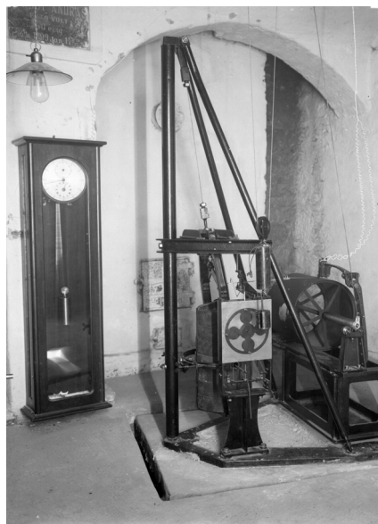
A kolozsvári egyetemi földrajzi intézet Mainka-féle földrengésjegyzőkészüléke (1912) [Kol1066] N-S komponens [Kol1067] E-W komponens
