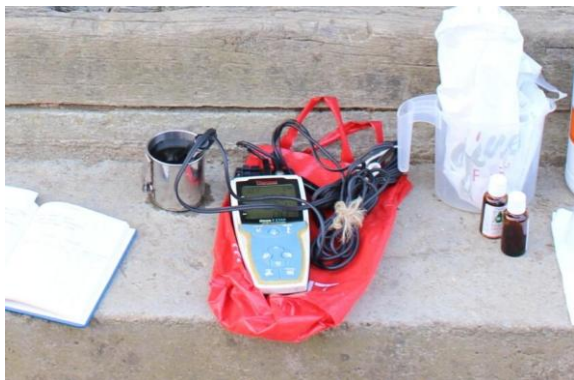
12. ábra: Thermo Orion 5 Star hordozható elektródás multiparaméter mérő
