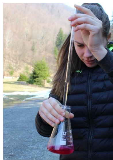
11. ábra: Az oldott CO 2 vizsgálata hagyományos titrálós módszerrel.
